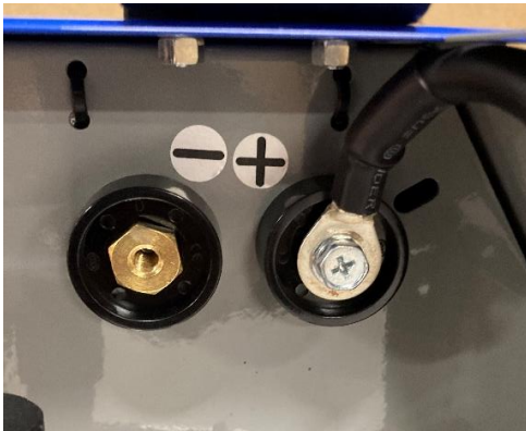
(10) ved rørflusstråd byttes polaritet fra pluss til minus. (11) Jordingsklemme settes på pluss.
