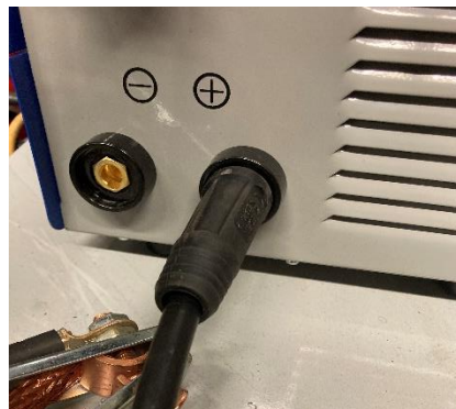
(10) ved rørflusstråd byttes polaritet fra pluss til minus. (11) Jordingsklemme settes på pluss.
