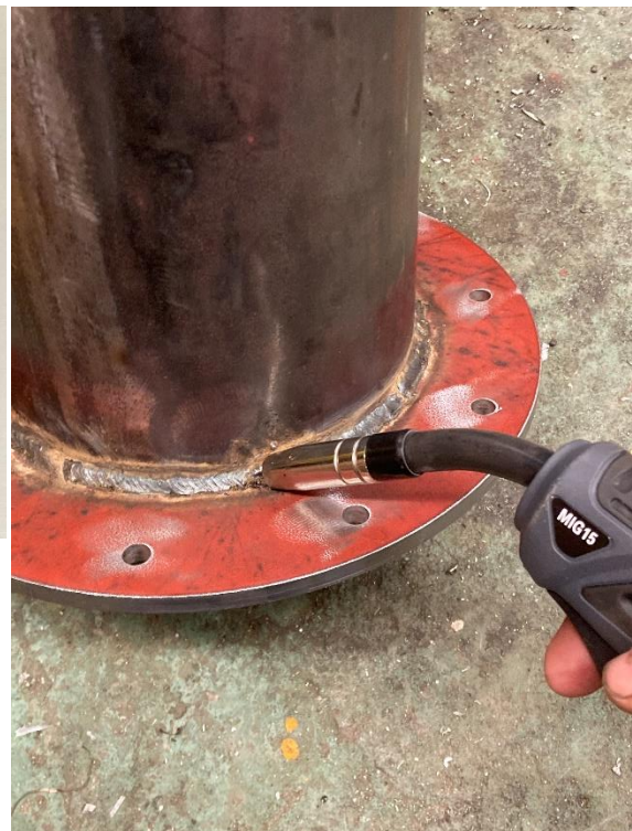
Bilde til høyre: Føres munnstykket mot høyre, kalles det motsveis. Føres det til venstre kalles det frasveis.
