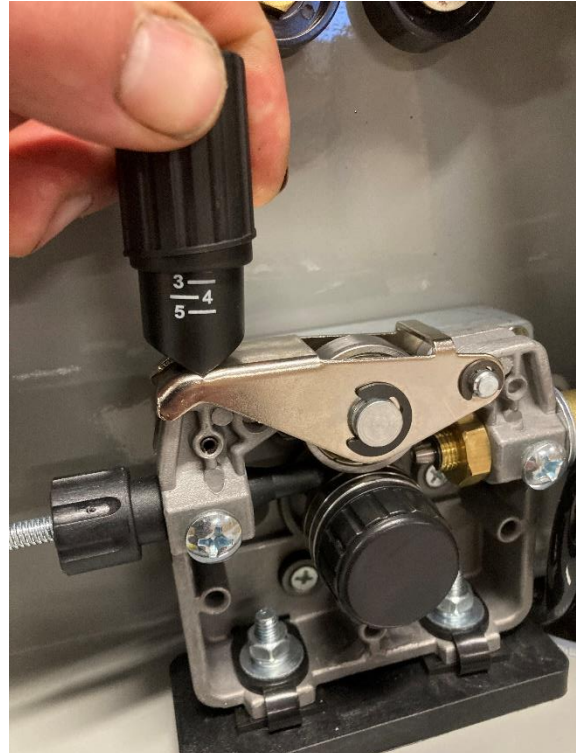
(7) Strammes nok til at matehjulet klarer å trekke frem tråden.
