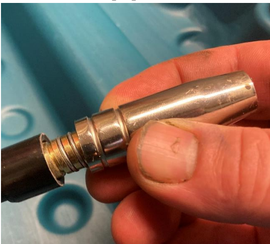
(8) Gasshylsen dreies med sola/urviseren uansett om den skal av eller på. (9) Kontaktrøret tres på tråden og skrues forsiktig fast.
